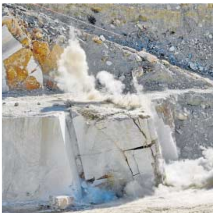
Voladura controlada realizada recientemente en Macael.
